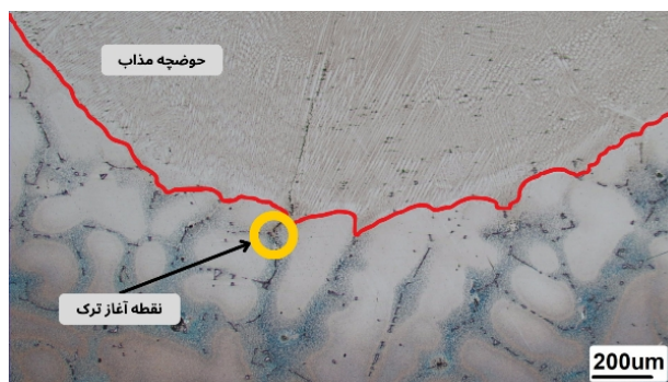
شکل 9- تصویری از محل آغاز ترک نمونه 1A-GTAW گرم بر میلی لیتر.
