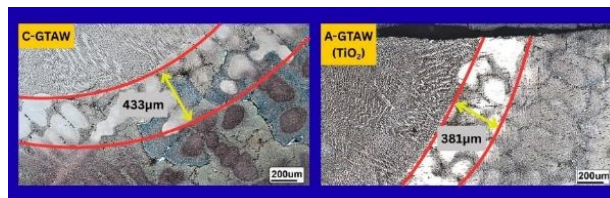
شکل 8- تصویری از محل آغاز ترک نمونه 1A-GTAW گرم بر میلی لیتر.
